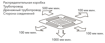
Пространство для обслуживания
